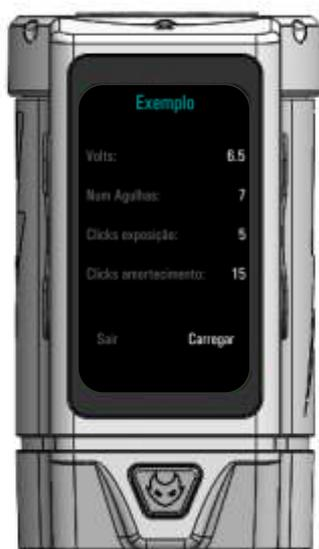
Esse processo agiliza a configuração da máquina, oferecendo acesso rápido aos valores de voltagem salvos, bem como às configurações utilizadas anteriormente na máquina durante um tipo específico de traço. Além disso, fornece informações sobre o número de agulhas utilizadas em um trabalho específico. Essa funcionalidade torna mais eficiente o trabalho, permitindo uma rápida retomada das configurações ideais para diferentes projetos.
